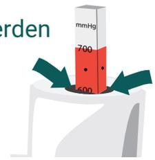
**ANMERKUNG:** Vakuum bis zum grünen Bereich am Messgerät aufbauen. Falls möglich sollte der grüne Bereich vollständig verdeckt sein, sodass er nicht mehr sichtbar ist.
