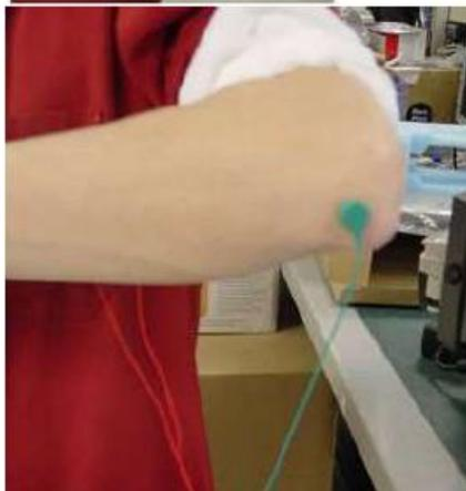
4. Mantenga su palma abierta y levante el brazo ligeramente (en un ángulo de 45 grados) y retenga la posición para mantenerlo a una velocidad constante. Usted notará un aumento de la actividad en el canal de EMG.
